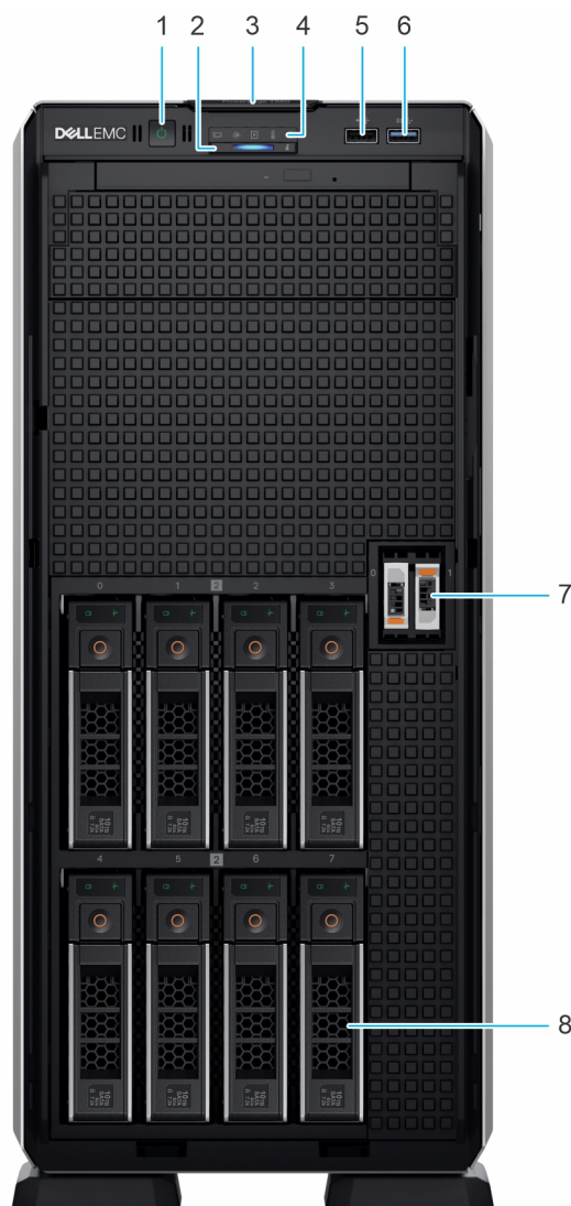
Figura 4. Vista anteriore del sistema con 8 unità da 3,5 pollici
